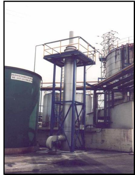
Desgasificación de CO<sub>2</sub> en aguas procedentes de plantas de ósmosis inversa e intercambio iónico. Material instalado : AISI 316. Caudal : 2 m<sup>3</sup>/h. Emisión : 25 mg/l Se emplean unidades del tipo difusibilidad cruzada que permiten optimizar el ratio líquido-gas con un consumo energético reducido.
