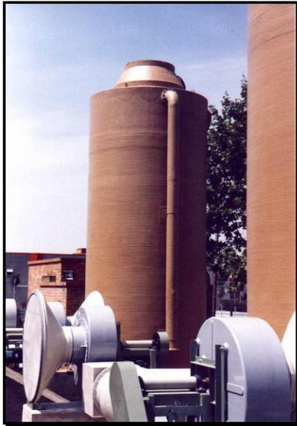
Stripping de tricloroetileno en efluentes de aguas industriales procedentes del desengrase de piezas metálicas. Materiales utilizados : Polipropileno y Poliester reforzado con fibra de vidrio. Unidades de contacto tipo QUIMIPLEX.
